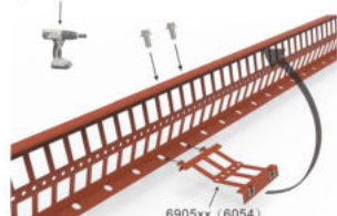
Skarv av snögrind med skarvstycke
